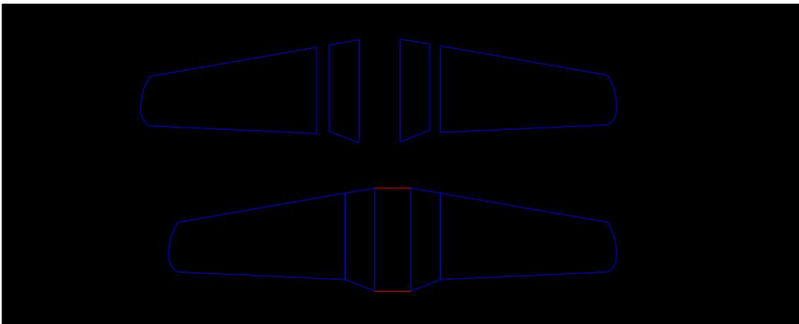
A baixo o esquema de colocação das fibras na asa, sendo 2 em cima e 2 em baixo:
