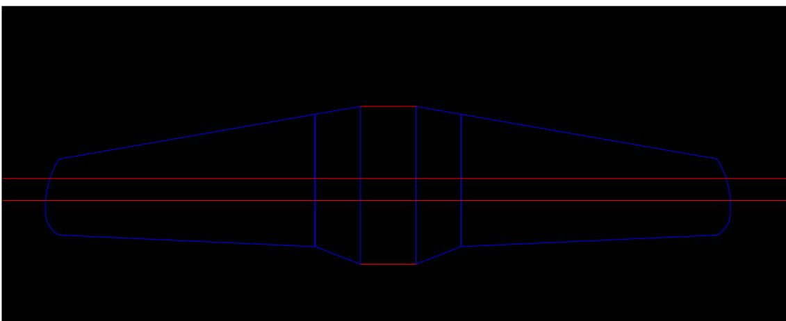
3- Passo, no esquema a baixo você vera como pode ser feito o esquema para fixar a asa, usando madeiras compensado de 3mm , sendo 2 pçs de 14x03cm e 2 depçs de 06,03cm, lembrando que a parte de baixo da asa, ficara solta ou pode ser colada após fixar as madeira que servirão de arruela para que os parafusos não entre no isopor.
